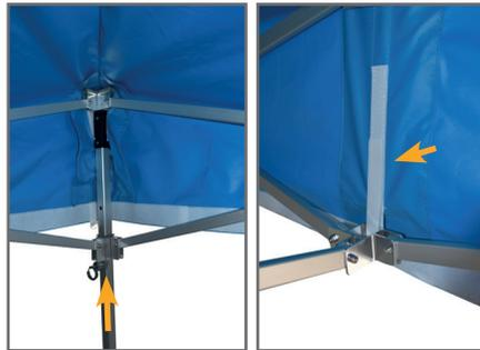
Drücken Sie die Zeltverbindung in den 4 Ecken über die Bein-Buchse an jedem Bein, bis es einrastet. Ziehen Sie dann die Klettadaptionen in der Dachmitte nach unten und befestigen Sie diese. Nun können Sie die Zeltfüsse in gewünschter Höhe einstellen.
