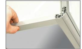
Demontieren Sie zunächst die oberen, seitlichen Profile mit der Lochbohrung für die Tischplatte. Stellen Sie danach die Platten in das Nut-Profil und setzen das obere Profil wieder als Abschluss darauf und ziehen es wieder fest. Wiederholen Sie diesen Schritt auf der anderen Seite. (Die seitlichen Platten können für den Transport im Gestell verbleiben)
